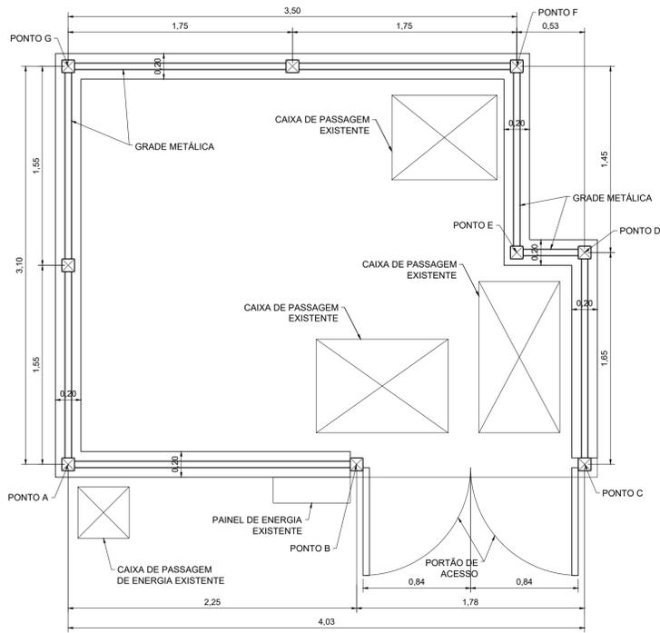
**GRADE DE FECHAMENTO ESTAÇÃO DE BOMBEAMENTO DE ESGOTO - PLANTA**
